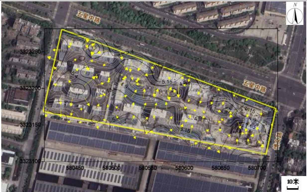
图 2.1-4 引用地勘地下水流向图
