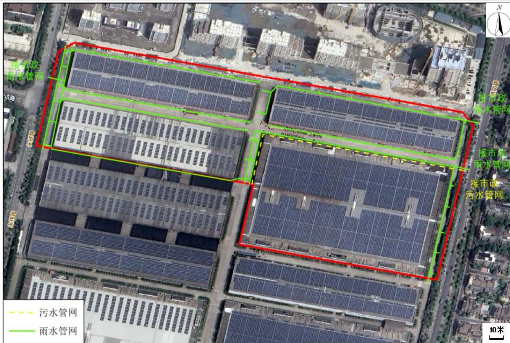
图 3.4-3 雨污管网分布图
