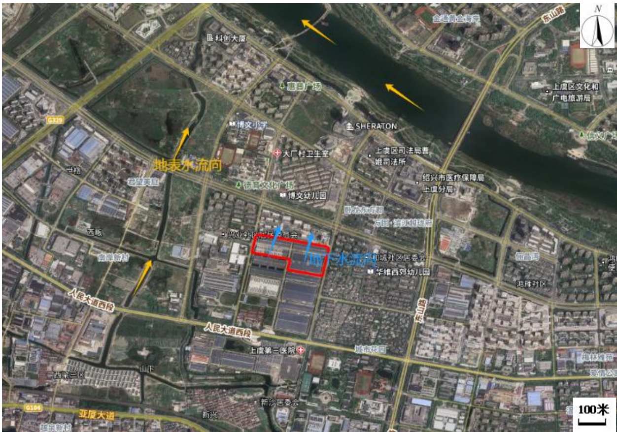
图2.1-5 初步判定调查地块地下水流向图（从西南流向东北）
